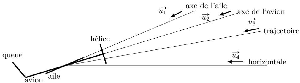
FIGURE 1 – Divers axes pour un vol rectiligne
