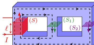
Le circuit est alimenté par un courant d'intensité  $I = 200$  mA. Le champ magnétostatique produit est guidé dans le circuit selon les lignes fléchées en pointillés et a pour intensité  $B = \mu_0 \mu_r NI / \ell$ .
