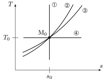
Exprimer la pente  $\frac{\partial T}{\partial s}$  au point  $M_0$  pour chaque courbe iso en fonction de  $T_0$ ,  $c_v$  et  $c_p$  :
