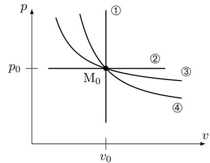
Exprimer la pente  $\frac{\partial p}{\partial v}$  au point  $M_0$  pour chaque courbe iso en fonction de  $p_0$ ,  $v_0$  et  $\gamma$  :
