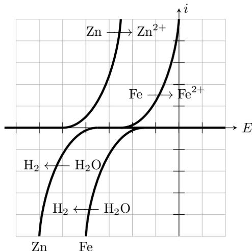
Le surpotentiel cathodique du couple  $H_2O/H_2$  n'est pas le même sur les deux métaux : un phénomène de corrosion différentielle peut apparaître, où la réduction de l'eau n'a pas lieu sur le métal qui est oxydé. On rappelle que le potentiel de corrosion (ou potentiel mixte) est celui pour lequel le courant anodique est égal au courant cathodique, sa valeur absolue est alors appelée courant de corrosion.
