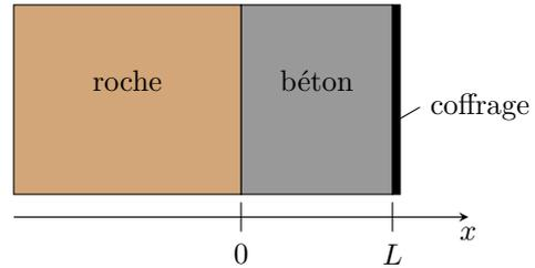
Le mur de béton est d'épaisseur  $L = 1,0\text{ m}$  et de conductivité thermique  $\lambda = 1,2\text{ W} \cdot \text{K}^{-1} \cdot \text{m}^{-1}$ . La prise en masse du béton est le siège d'une réaction chimique exothermique dégageant une puissance volumique  $p_v$ .
