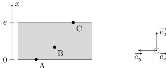
La température de la face inférieure contenant A est  $T_A = 8^\circ\text{C}$  et celle de la face supérieure contenant C est  $T_C = 18^\circ\text{C}$ . La température en un point  $M(x, y, z)$  du béton ne dépend que de  $x$  en régime stationnaire.
