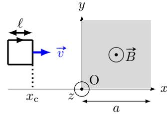
Exprimer le flux du champ magnétique  $\Phi = \iint_S \vec{B} \cdot d\vec{S}$  en fonction de  $B$ ,  $x_c$ ,  $\ell$  et  $a$  si :
