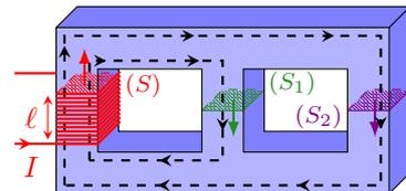
Le circuit est alimenté par un courant d'intensité  $I = 200$  mA. Le champ magnétostatique produit est guidé dans le circuit selon les lignes fléchées en pointillés et a pour intensité  $B = \mu_0 \mu_r NI / \ell$ .
