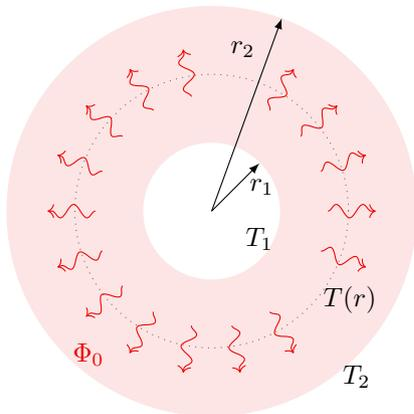
a) Les conditions aux limites imposent  $\Phi_0$  et  $T(r_1) = T_1$ . Déterminer  $T(r)$  en fonction notamment de  $T_1$  et  $\Phi_0$ .
