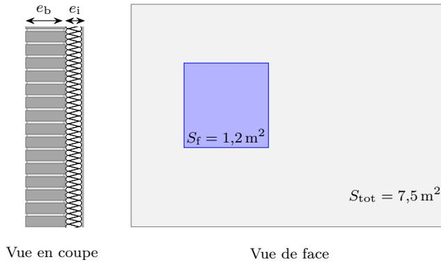
Un pan de mur de surface totale  $S_{\text{tot}} = 7,5 \text{ m}^2$  est composé d'un mur de brique d'épaisseur  $e_b = 20 \text{ cm}$ , de conductivité thermique  $\lambda_b = 0,70 \text{ W} \cdot \text{m}^{-1} \cdot \text{K}^{-1}$  et d'un isolant en fibre de bois d'épaisseur  $e_i = 12 \text{ cm}$ , de conductivité thermique  $\lambda_i = 0,036 \text{ W} \cdot \text{m}^{-1} \cdot \text{K}^{-1}$ .
