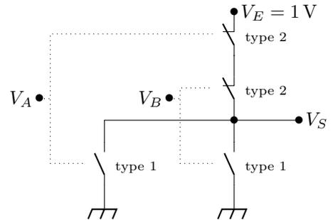
Déterminer la valeur de la tension de sortie  $V_S$  en volts dans le cas où les tensions d'entrée sont telles que :
