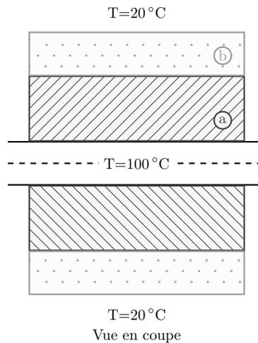
Un mince tuyau métallique d'une longueur  $L$  et de rayon 1 cm transporte de la vapeur à 100°C. Celui-ci est couvert par deux couches d'isolants :
