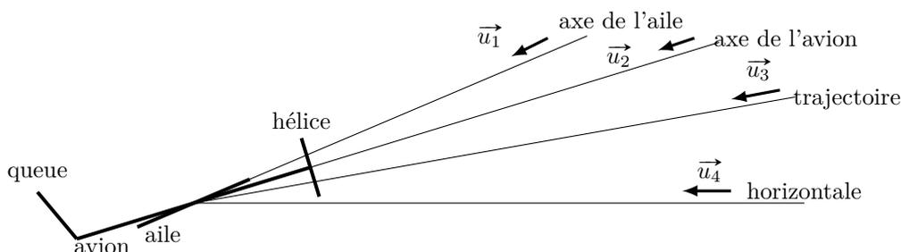
FIGURE 1 – Divers axes pour un vol rectiligne
