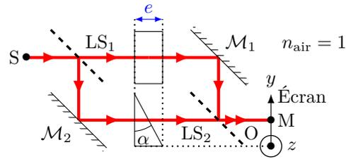
Les lames séparatrices LS atténuent l'éclairement  $I_0$  des rayons d'un facteur 2. On rappelle que l'amplitude  $S_0$  d'un rayon est liée à son éclairement de telle manière que  $I_0$  est proportionnel à  $S_0^2$ . La différence de marche entre les deux rayons 1 et 2 est :
