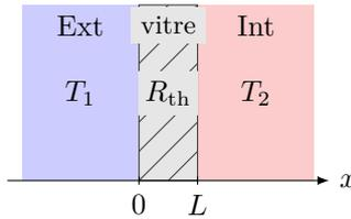
Les échanges thermiques aux interfaces en  $x = 0$  et  $x = L$  sont régis par la relation de Newton. Si l'on prend en compte les effets conducto-convectifs aux deux interfaces, on obtient le système :
