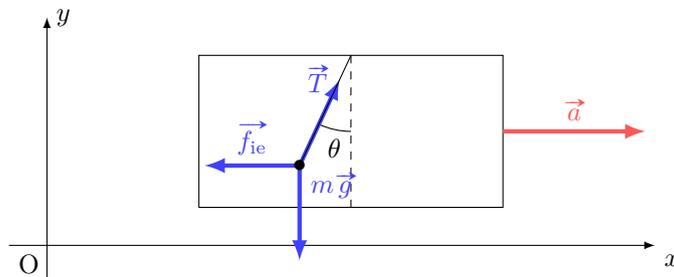
On rappelle que la force d'inertie d'entraînement vaut  $\vec{f}_{ie} = -m\vec{a}$ . Sous l'action de cette force, le pendule se stabilise pour une valeur particulière de l'angle  $\theta$  notée  $\theta_e$ .
