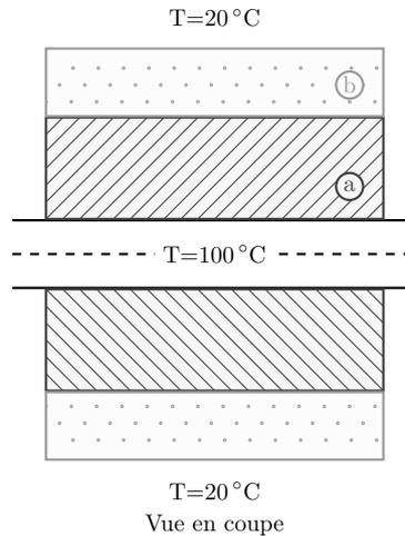
Un mince tuyau métallique d'une longueur  $L$  et de rayon 1 cm transporte de la vapeur à  $100^\circ\text{C}$ . Celui-ci est couvert par deux couches d'isolants :
