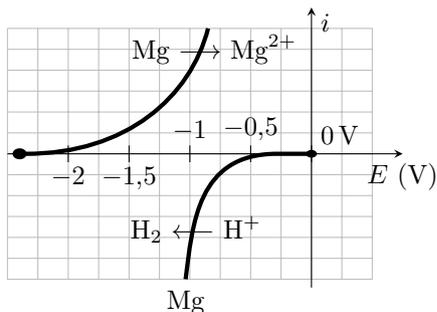
Une lame de magnésium est plongée dans une solution aqueuse acidifiée, maintenue à  $\text{pH} = 4$ . Le magnésium (couple  $\text{Mg}^{2+}/\text{Mg}$ ) est alors corrodé par les ions  $\text{H}^+$  (couple  $\text{H}^+/\text{H}_2$ ).
