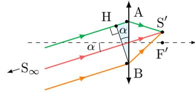
a) En sachant que le plan passant par  $H$  et  $B$  est une surface d'onde pour la source  $S$ , exprimer la différence de chemin optique  $(SA) - (SB)$  en fonction de la distance  $AB$  et de l'angle  $\alpha$ .
