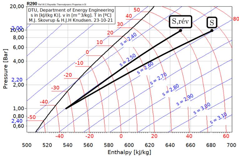
**17.7 c)** D'après le premier principe industriel, on a  $w_{\text{rév}} = h_{S,\text{rév}} - h_E = 650 - 540 = 110 \text{ kJ} \cdot \text{kg}^{-1}$ .
