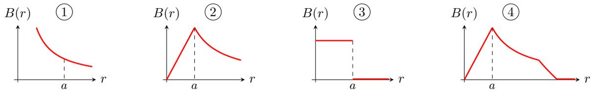
Le champ magnétique d'un conducteur cylindrique de rayon  $a$  parcouru par un courant volumique uniforme est donné par
