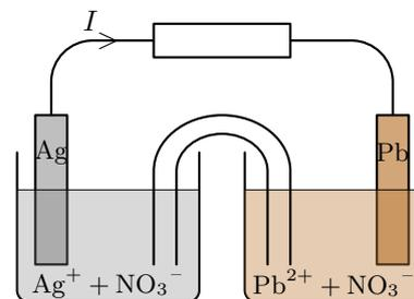
Le compartiment de gauche correspond à une lame d’argent plongeant dans une solution de nitrate d’argent (volume  $V_1 = 100,0\text{ mL}$  et concentration  $C_1 = 0,100\text{ mol}\cdot\text{L}^{-1}$ ), mettant en jeu le couple  $\text{Ag}^+/\text{Ag}$ . Celui de droite correspond à une lame de plomb plongeant dans une solution de nitrate de plomb ( $V_2 = V_1$  et  $C_2 = C_1$ ), mettant en jeu le couple  $\text{Pb}^{2+}/\text{Pb}$ .
