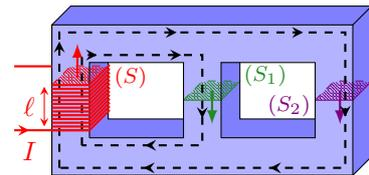
Le circuit est alimenté par un courant d'intensité  $I = 200$  mA. Le champ magnétostatique produit est guidé dans le circuit selon les lignes fléchées en tirets et a pour intensité  $B = \mu_0 \mu_r NI / \ell$ .
