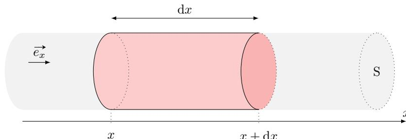
Le conducteur thermique est le siège d'une production algébrique volumique d'énergie de puissance  $p_{\text{prod}}$  (effet Joule, réaction chimique, etc.).
