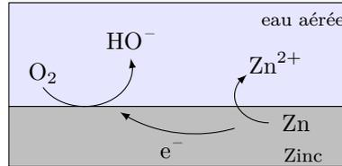
Les deux couples rédox intervenant dans la réaction d'oxydoréduction sont  $O_2/HO^-$  et  $Zn^{2+}/Zn$ .
