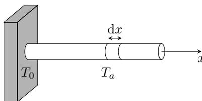
a) L'élément de volume  $S dx$  de la tige situé entre  $x$  et  $x + dx$  reçoit une puissance de la part de l'air égale à :
