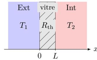
La situation est étudiée en régime permanent. La conduction thermique envisagée est telle que la résistance thermique de la vitre est  $R_{\text{th},v} = \frac{L}{\lambda S}$ .
