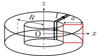
Le champ magnétostatique créé par cette bobine à l'intérieur du tore s'écrit :  $\vec{B} = B(r)\vec{e}_\theta$ .
