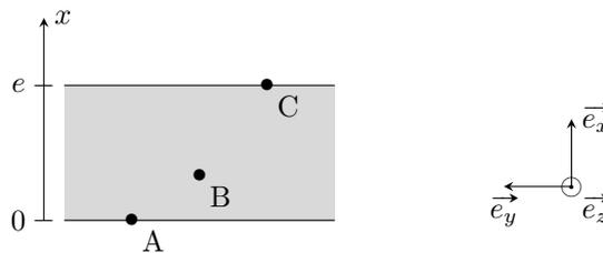
La température de la face inférieure contenant A est  $T_A = 8^\circ\text{C}$  et celle de la face supérieure contenant C est  $T_C = 18^\circ\text{C}$ . La température en un point  $M(x, y, z)$  du béton ne dépend que de  $x$  en régime stationnaire.
