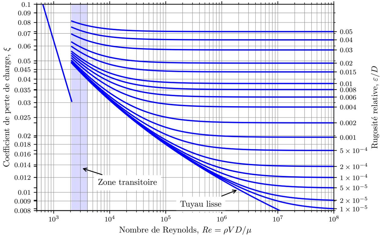
a) On donne  $Re = 2 \times 10^4$  le nombre de Reynolds de l'écoulement,  $D = 20$  cm le diamètre de la canalisation et  $\varepsilon = 4$  mm la rugosité absolue de la conduite.
