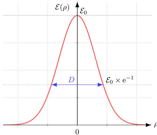
On mesure d'abord la puissance  $P = 5,00 \text{ mW}$  contenue dans le faisceau à l'aide d'un détecteur dont le diamètre est beaucoup plus grand que le faisceau. Cela revient, pour un laser continu, à intégrer son éclairement sur un disque de rayon  $\rho$  infini et à diviser par une durée  $\Delta t = 1 \text{ s}$ , soit :
