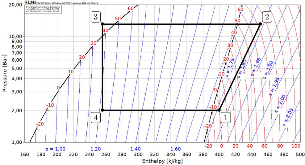
a) Le fluide reçoit du travail dans le compresseur, ce qui a pour effet d'augmenter la pression ainsi que la température à une température supérieure à celle de la source chaude.
