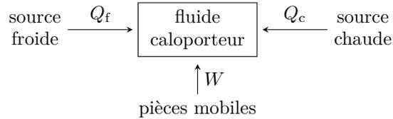
a) S'il s'agit d'un moteur, indiquer le signe de chaque transfert énergétique  $W$ ,  $Q_f$  et  $Q_c$ .
