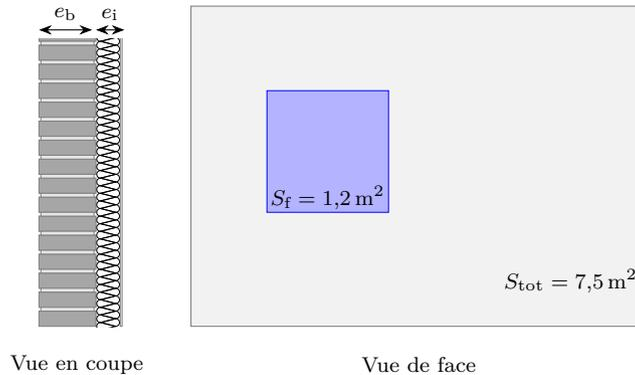
Un pan de mur de surface totale  $S_{tot} = 7,5 \text{ m}^2$  est composé d'un mur de brique d'épaisseur  $e_b = 20 \text{ cm}$ , de conductivité thermique  $\lambda_b = 0,70 \text{ W} \cdot \text{m}^{-1} \cdot \text{K}^{-1}$ , et d'un isolant en fibre de bois d'épaisseur  $e_i = 12 \text{ cm}$ , de conductivité thermique  $\lambda_i = 0,036 \text{ W} \cdot \text{m}^{-1} \cdot \text{K}^{-1}$ .
