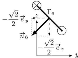
5.3 a) Il y a trois façons de modifier un flux : modifier la surface, modifier le champ, changer l'angle entre le vecteur normal à la surface et le champ. Ici, comme  $\vec{B} \wedge \vec{n} = \vec{0}$  à  $t = 0$ , les deux vecteurs sont colinéaires. Comme le cadre tourne autour d'un de ses côtés, l'angle entre  $\vec{n}$  et  $\vec{B}$  varie au cours du temps.
