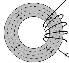
**21.2 a)** D'après la règle de la main droite, les lignes de champ sont orientées dans le sens trigonométrique. Les vecteurs  $\vec{B}_1$  et  $\vec{B}_3$  sont donc dans le sens de la main droite.
