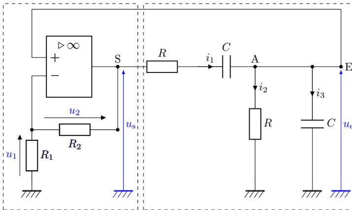
a) Le pont diviseur de tension du cadre de gauche permet d'écrire une relation entre  $u_1$  et  $u_s$ . Écrire cette relation.
