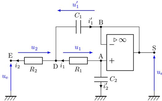
a) Exprimer la loi des nœuds au point D en fonction des intensités  $i_1$ ,  $i_2$  et  $i'_1$ .
