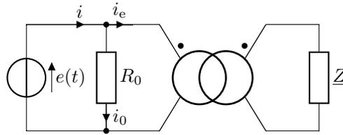
où  $e(t)$  est une tension alternative de valeur efficace  $E = 230$  V et de fréquence 50 Hz,  $R_0 = 100 \Omega$ .
