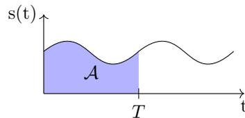
En régime périodique, la valeur moyenne de l'intensité du courant parcourant un condensateur et la valeur moyenne de la tension aux bornes d'une bobine sont nulles.
