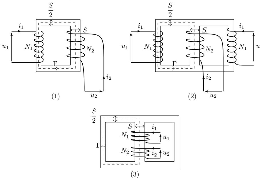
Les courants génèrent une excitation magnétique  $\vec{H}$ . On note  $B_1$  (respectivement  $B_2$ ) la norme du champ magnétique et  $\Phi_1$  (resp.  $\Phi_2$ ) le flux magnétique dans le primaire (resp. secondaire). L'excitation magnétique et les champs magnétiques sont orientés selon le contour  $\Gamma$ .
