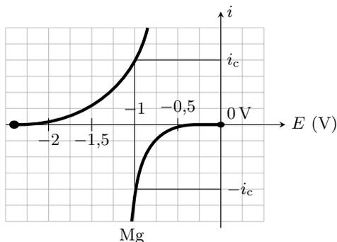
**30.8 c)** La demi-équation électronique s'écrit  $2\text{H}^+ + 2\text{e}^- = \text{H}_2$ , il faut donc échanger 2 moles d'électrons pour former 1 mole de dihydrogène. Ainsi, pour la formation de  $n$  moles de H<sub>2</sub>, il faut  $2n$  moles d'électrons, d'où une charge totale  $2n\mathcal{F}$ .
