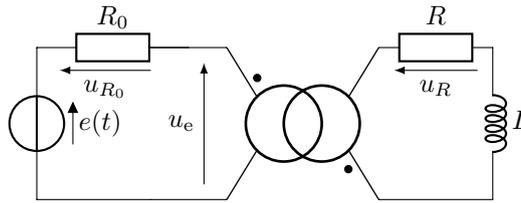
où  $e(t)$  est une tension alternative de valeur efficace  $E = 230$  V et de fréquence 50 Hz, où  $R_0 = R = 100 \Omega$  et où  $L = 0,30$  H.
