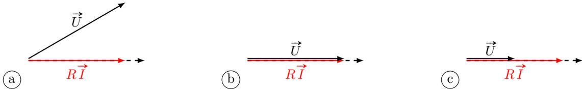
b) Une résistance  $R$  de  $10 \Omega$  en série avec une bobine  $L$  d'inductance  $2,0 \text{ mH}$ .
