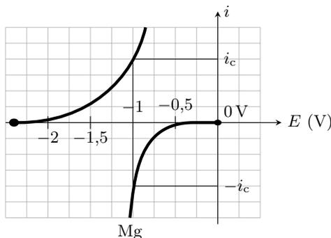
23.8 c) La demi-équation électronique s'écrit  $2\text{H}^+ + 2\text{e}^- = \text{H}_2$ , il faut donc échanger 2 moles d'électrons pour former 1 mole de dihydrogène. Ainsi, pour la formation de  $n$  moles de H<sub>2</sub>, il faut  $2n$  moles d'électrons, d'où une charge totale  $2n\mathcal{F}$ .
