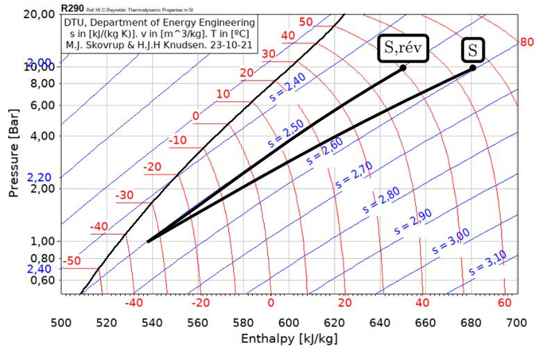
15.7 c) D'après le premier principe industriel, on a  $w_{\text{rév}} = h_{S,\text{rév}} - h_E = 650 - 540 = 110 \text{ kJ} \cdot \text{kg}^{-1}$ .
