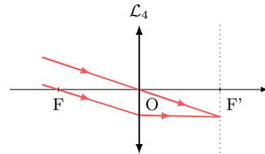
**8.5 a)** Les rayons incidents étant parallèles à l'axe optique, d'après le théorème de Malus, les surfaces d'onde sont perpendiculaires à l'axe optique.
