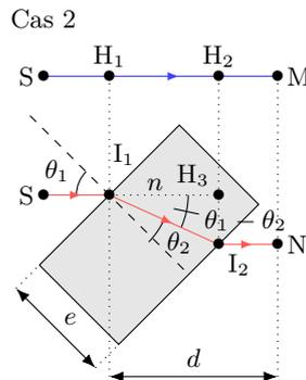
**8.9 d)** Les chemins optiques (SI<sub>1</sub>) et (SH<sub>1</sub>), ainsi que (I<sub>2</sub>N) et (H<sub>2</sub>M) sont égaux, on peut donc écrire :
