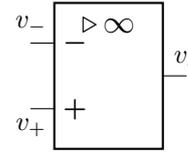
a) Écrire la fonction de transfert définie en régime harmonique par  $\underline{\mu} = \frac{s}{v_+ - v_-}$ .
