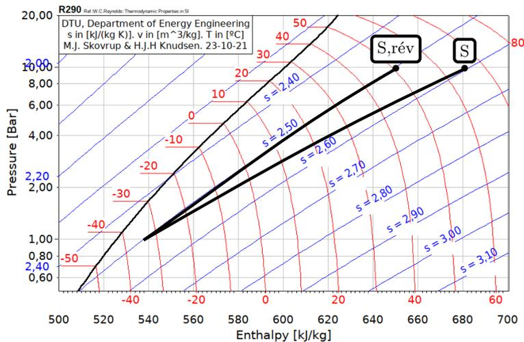
**16.7 c)** D'après le premier principe industriel, on a  $w_{\text{rév}} = h_{S,\text{rév}} - h_E = 650 - 540 = 110 \text{ kJ} \cdot \text{kg}^{-1}$ .
