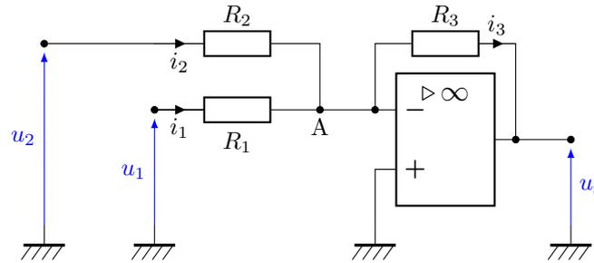
a) Exprimer la loi des nœuds au point A en fonction des intensités  $i_1$ ,  $i_2$  et  $i_3$ .
