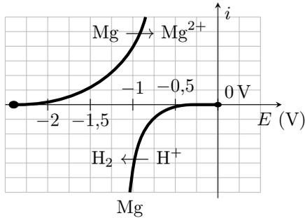
Une lame de magnésium est plongée dans une solution aqueuse acidifiée, maintenue à pH = 4. Le magnésium (couple  $\text{Mg}^{2+}/\text{Mg}$ ) est alors corrodé par les ions  $\text{H}^+$  (couple  $\text{H}^+/\text{H}_2$ ).
