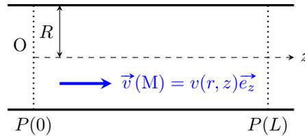
Du fait des symétries du problème, on cherche en coordonnées cylindriques un champ des vitesses et un champ de pression de la forme  $\vec{v}(M) = v(r, z)\vec{e}_z$  et  $P(M) = P(r, z)$ .
