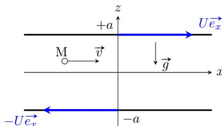
On suppose le champ eulérien des vitesses dans l'écoulement du type  $\vec{v}(M) = v(z)\vec{e}_x$ . Le champ de pression sera supposé ne dépendre ici que de  $z$ . On note  $\vec{g} = -g\vec{e}_z$  le champ de pesanteur local.
