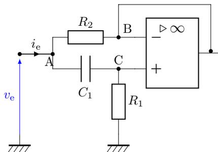
$$\underline{Z}(\omega) = R_2 \frac{1 + jR_1C_1\omega}{1 + jR_2C_1\omega}$$
