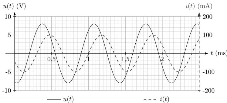
La tension  $u(t)$  et l'intensité électrique  $i(t)$  de l'association série d'une bobine et d'un conducteur ohmique sont mesurées expérimentalement (courbes ci-contre). L'impédance de ce montage est
