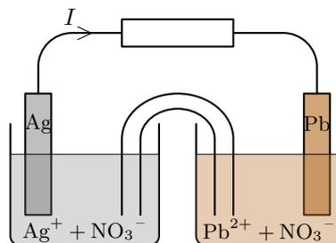
Le compartiment de gauche correspond à une lame d’argent plongeant dans une solution de nitrate d’argent (volume  $V_1 = 100,0$  mL et concentration  $C_1 = 0,100$  mol · L<sup>-1</sup>), mettant en jeu le couple Ag<sup>+</sup>/Ag. Celui de droite correspond à une lame de plomb plongeant dans une solution de nitrate de plomb ( $V_2 = V_1$  et  $C_2 = C_1$ ), mettant en jeu le couple Pb<sup>2+</sup>/Pb.
