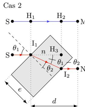
**9.9 d)** Les chemins optiques (SI<sub>1</sub>) et (SH<sub>1</sub>), ainsi que (I<sub>2</sub>N) et (H<sub>2</sub>M) sont égaux, on peut donc écrire :
