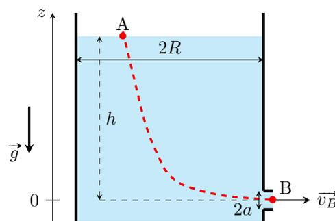
a) En appliquant la relation de Bernoulli à la ligne de courant allant de A à B, établir une relation liant  $v_A$ ,  $v_B$ ,  $g$  et  $h$ .
