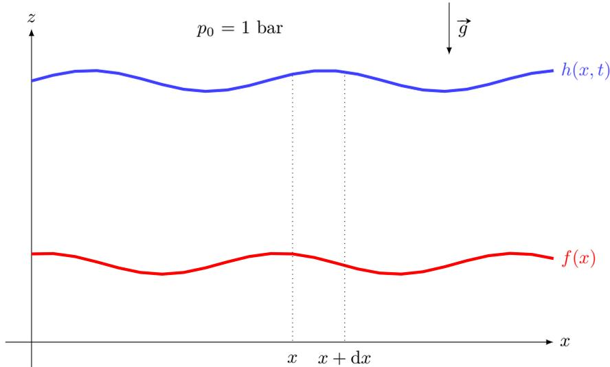
a) On suppose que la pression dans le fluide est de type hydrostatique, c'est-à-dire que la pression  $p(M)$  en un point  $M$  vaut  $p_0 + \mu g \times \Delta H$ , où  $\Delta H$  est la hauteur de la colonne de fluide au-dessus du point  $M$ . Donner l'expression de la pression  $p(x, z, t)$  en un point de l'eau, en fonction de  $\mu$ ,  $g$ ,  $h(x, t)$  et  $z$ .
