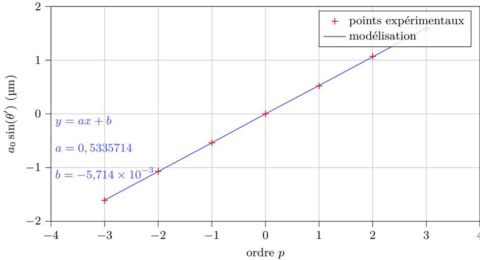
La quantité  $a_0 \sin(\theta)$  est homogène à une longueur alors que  $p$  est sans dimension. Ainsi,  $a$  est homogène à une longueur.
