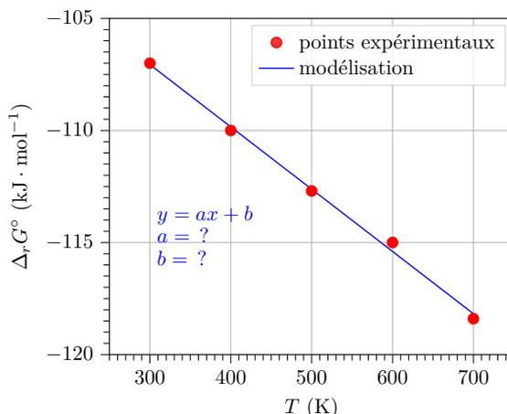
On suppose que  $\Delta_r H^\circ$  et  $\Delta_r S^\circ$  sont indépendants de la température (approximation d'Ellingham) et on rappelle la relation  $\Delta_r G^\circ = \Delta_r H^\circ - T \times \Delta_r S^\circ$ .
