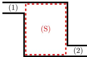
a) Exprimer la masse de fluide  $dm_1$  qui entre dans (S) pendant la durée élémentaire  $dt$ , à l'aide du débit massique entrant  $D_{m1}$ .
