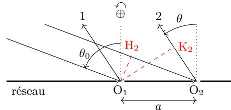
Il en est de même pour le chemin optique de  $O_1$  jusqu'à l'infini sur le rayon émergent 1 et pour celui de  $K_2$  jusqu'à l'infini sur le rayon émergent 2.
