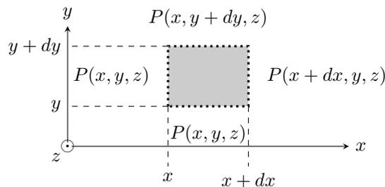
a) Exprimer la force de pression  $d\vec{F}_g$  s'exerçant sur la paroi latérale gauche de la particule en fonction de  $P(x, y, z)$ ,  $dy$  et  $dz$ .
