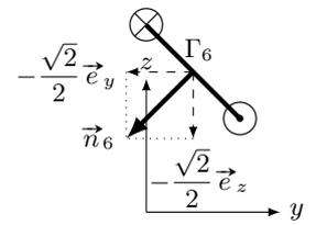
6.3 a) Il y a trois façons de modifier un flux : modifier la surface, modifier le champ, changer l'angle entre le vecteur normal à la surface et le champ. Ici, comme  $\vec{B} \wedge \vec{n} = \vec{0}$  à  $t = 0$ , les deux vecteurs sont colinéaires. Comme le cadre tourne autour d'un de ses côtés, l'angle entre  $\vec{n}$  et  $\vec{B}$  varie au cours du temps.
