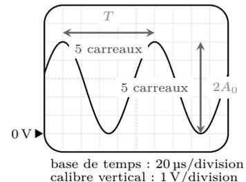
**5.5 b)** Nous avons 5 carreaux pour la double amplitude, soit  $2U_0 = 5 \times 1 = 5 \text{ V}$ . Donc, on a  $U_0 = 2,5 \text{ V}$ .
