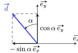
**11.5 a)** La composante suivant  $\vec{e}_x$  du poids est  $P_x = \vec{P} \cdot \vec{e}_x = P \cos(\alpha + \pi/2) = -P \sin(\alpha)$ . De même, sa composante suivant  $\vec{e}_y$  s'écrit  $P_y = \vec{P} \cdot \vec{e}_y = P \cos(\alpha + \pi) = -P \cos(\alpha)$ . Ainsi, le poids s'écrit
