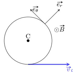
15.10 f) Le périmètre du cercle parcouru vaut  $L = 2\pi R$  et donc  $T = \frac{2\pi R}{v_0} = 2\pi \frac{mv_0}{|q|B} \frac{1}{v_0} = 2\pi \frac{m}{|q|B}$ .
